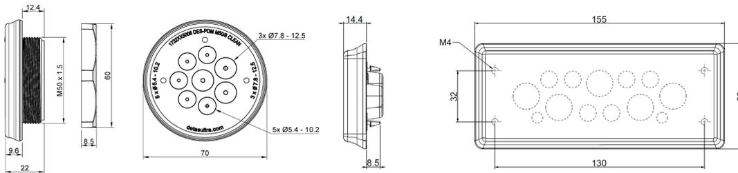
**Kabeldurchführungsplatte mit Innenrahmen DES-PDM CLEAN**
