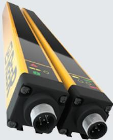
Der EOS4 Sicherheitsvorhang mit einer schmalen Bauform von 30 x 28 mm und einer Auflösung von 14/30 mm oder 60 mm für die Zugangskontrolle. Ausführungen mit einer hohen Schutzart bis IP69K, ATEX, hohen Reichweiten und Heizungen für niedrigen Temperaturen. Die Installation ist ohne Programmierung möglich.
